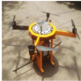
Gambar 2. Drone pemupuk secara keseluruhan [11].
