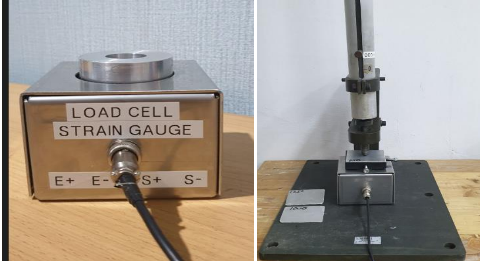
Gambar 1 : Pemasangan Load cell
