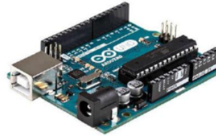
Fig. 3. Arduino Uno Module [9].
